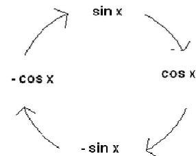
Die Sinus- und Cosinusfunktionen bilden zusammen ein Ableitungskreislauf (siehe Abb. 10<sup>31</sup>). In der Abbildung stellt jeder Pfeil einen Ableitungsvorgang dar. Somit gilt beispielsweise:  $(\sin x)' = \cos x$ . Bei den folgenden Rechnungen werden die Maxima von  $\sin x$  und  $-\sin x$  benötigt. Diese rechne ich vorab aus (Rechnung siehe Anhang).
