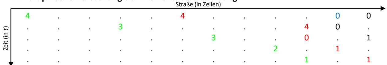
Es wird eine einspurige Straße mit  $v_{max} = 4$  dargestellt. Es fahren zwei Fahrzeuge und es stehen zwei mit  $v = 0$ . Das grüne Fahrzeug reagiert auf das blaue, welches mit der Geschwindigkeit  $v = 0$  fährt und bremst mit der Wahrscheinlichkeit  $p_b = 50\%$  frühzeitig ab. Es kann den gestauten Bereich ohne anzuhalten durchqueren. Das rote Fahrzeug reagiert nicht auf die stehenden Fahrzeuge und fährt mit  $v_{max} = 4$  bis vor das Stauende und stoppt abrupt. Es muss anhalten.
