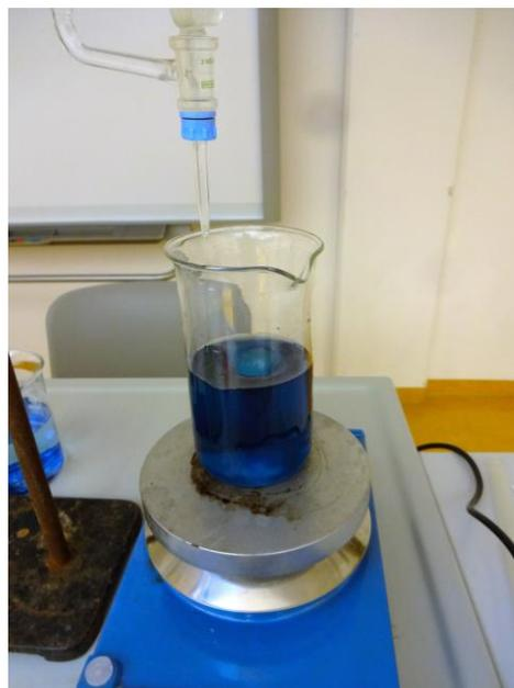
**Bild 12** Farbton der Analyselösung nach der Titration
