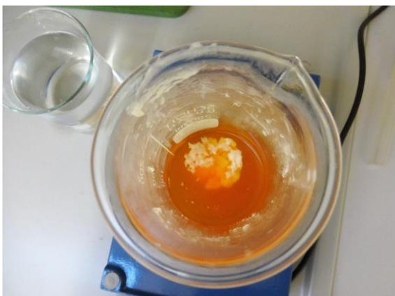
**Bild 9** Farbton der Analyselösung (Versuch „Rexona“) vor der Titration
