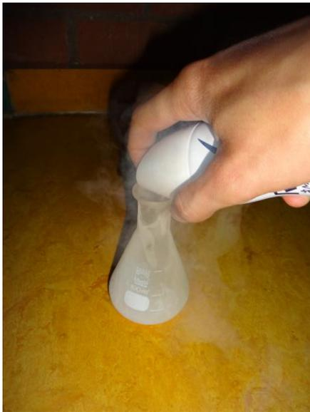
**Bild 7** Abfüllen des Rexona Deodorants unter Abkühlung aufgrund des Freiwerdens von Butan und Propan
