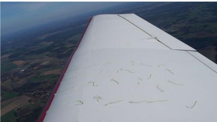
Abbildung 15: Strömung ist abgerissen
