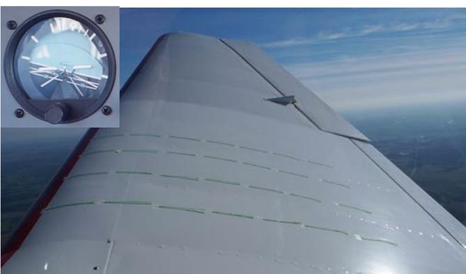
Abbildung 17: Strömung liegt an
