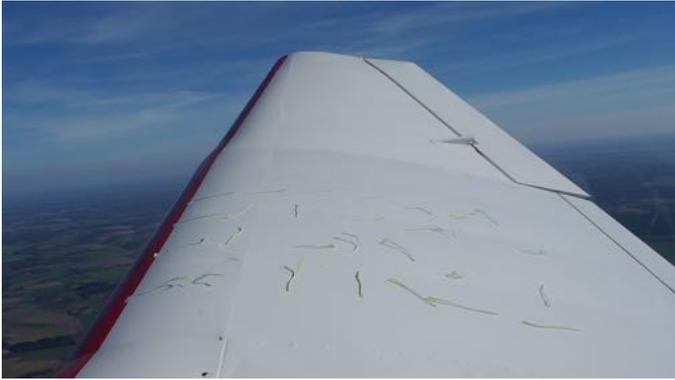
Abbildung 19: Strömung ist abgerissen
