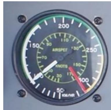
Abbildung 20: Fahrtmesser bei Strömungsabriss im Kurvenflug
