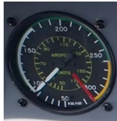
Abbildung 16: Fahrtmesser bei Strömungsabriss
