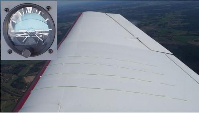
Abbildung 13: Strömung liegt an
