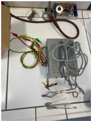
Vielfachmessgerät, Verbindungsleitungen mit Krokodilklemmen, Spatel und Tiegelzange
