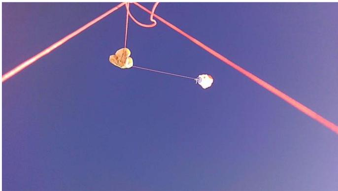
Abbildung 20: Die Reste des Ballons haben sich um das Seil gewickelt und hindern den Fallschirm, sich komplett auszubreiten
