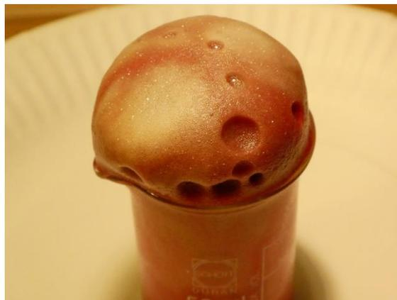
Zersetzung von Wasserstoffperoxid in Wasser und Sauerstoff, katalysiert durch das Enzym Katalase, unter Schaumbildung
