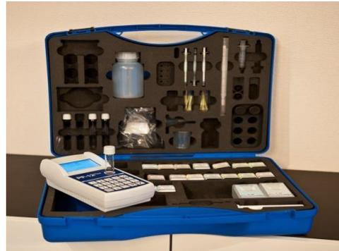
Abbildung 7: Analysenkoffer mit Photometer der Firma MACHEREY-NAGEL
