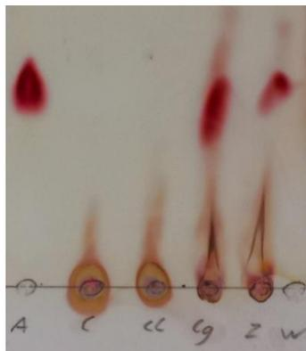
Abbildung 19: Dünnschichtchromatografie mit Aspartam - von links nach rechts aufgetragen sind Aspartam, Coca-Cola®, Coca-Cola Life®, Coca-Cola Light®, Coca-Cola Zero® und destilliertes Wasser
