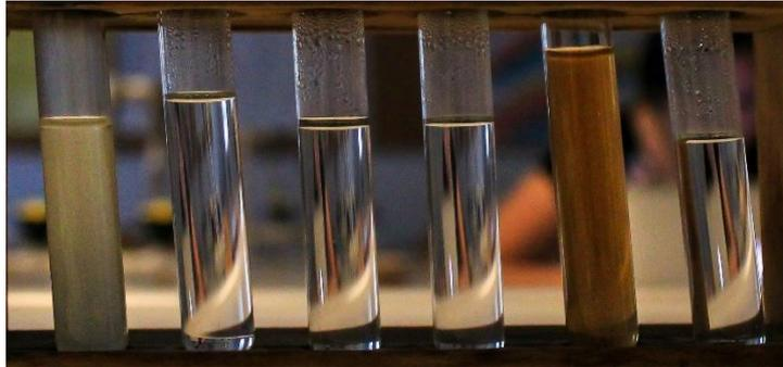
Abbildung 18: Cyclamat-Nachweis - von links nach rechts jeweils mit den Proben Kandisin, Coca-Cola®, Coca-Cola Life®, Coca-Cola Light®, Coca-Cola Zero® und destilliertem Wasser
