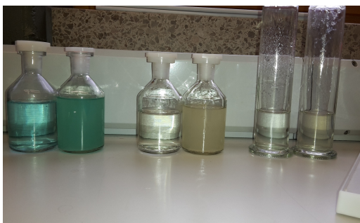
Abb. 7: Fertige Proben: mit Kupfersulfat (li.), nach dem Wasserbad (mi.), nach der Sauerstoffzufuhr (re.)
