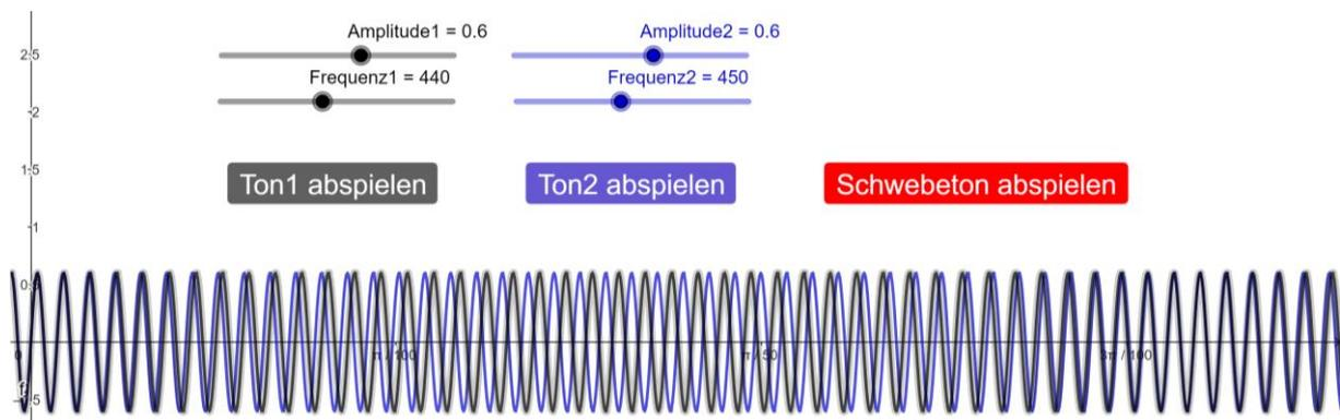
Abbildung 8: Experiment zu Schwebung auf GeoGebra: Wellenbild von Ton1 und 2
